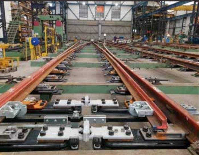
El sistema de fijación Delkor Eggs para desvíos se desarrolló específicamente para la **fijación directa de desvíos, cruza- mientos y aparatos de dilatación** para vías en placa para así proporcionar una alta atenuación de las vibraciones. Ha sido utilizado por primera vez en Cologne, Alemania, a finales de los años 70, básicamente el diseño sigue siendo el mismo hoy en día.
